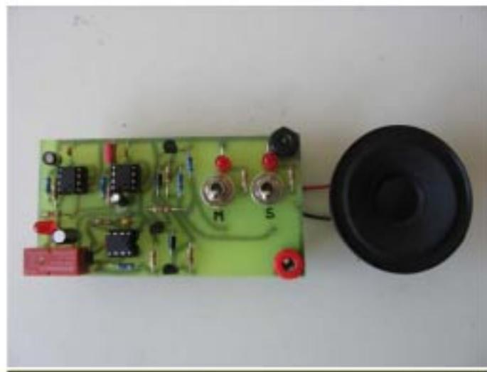
**NAMJENA:** Sklop upozorava vozače ako nije upaljeno svjetlo kada je motor pokrenut, odnosno da svjetla nisu ugašena kada je motor ugašen.
