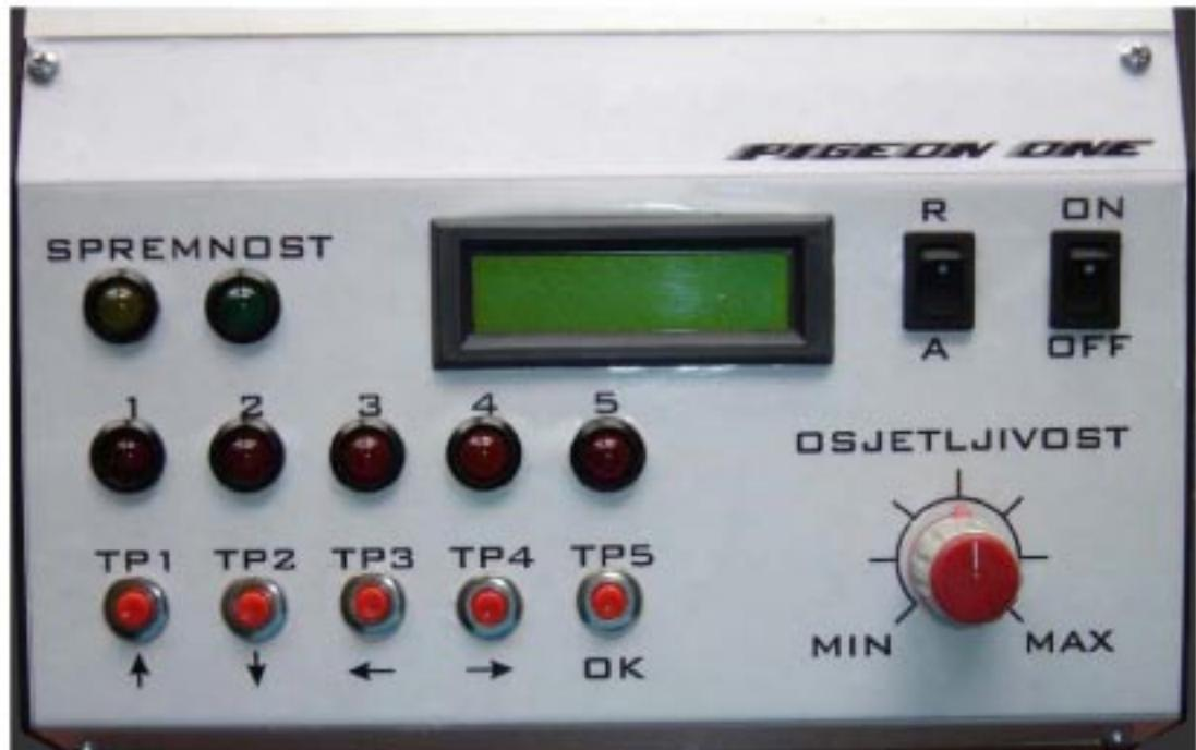
**Opis uređaja:** "Mozak" sklopa je atmelov mikrokontroler AT89S8252. Sklop se napaja iz gradske mreže (220V ~) ili 12V iz akumulatora. U uređaj se može priključiti do pet mikrofona. Filter osigurava propuštanje signala frekvencije od 300 do 3000 Hz. Ima ručni i automatski mod rada i moguće je podešavati osjetljivost mikrofona.
