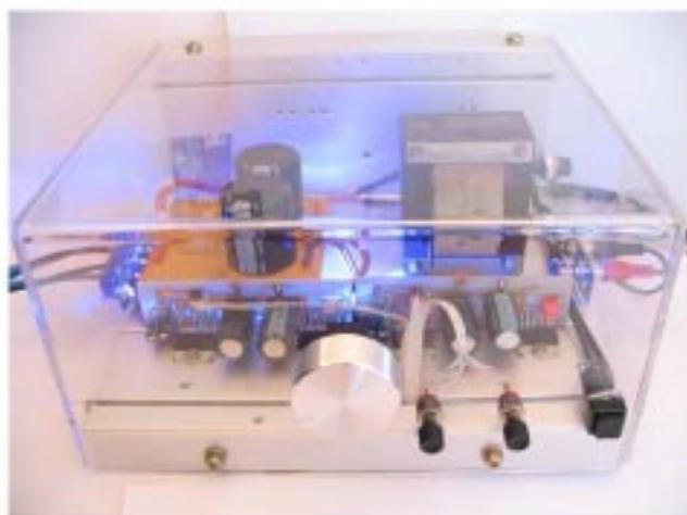
**Princip rada:** Pojačalo je vezano u mosnomo spoju. prednost je to što na izlazu ne moramo koristiti vezni kondenzator koji kvari frekvencijske osobine na niskim frekvencijama. Imamo dva priključka za stand-by i mute koji su na istoj točci. Mute i stand-by će se također pobrinuti da pri uključenju ne čujemo POP zvuk.
