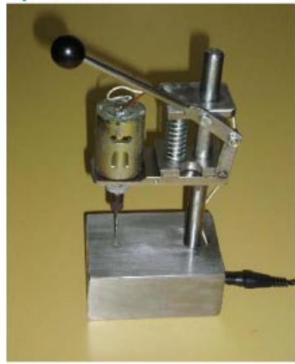
**MOGUĆNOSTI:** Kod rada uređaja se koristi istosmjerni motor (12V) – za brzu i jednostavnu transformaciju napona iz gradske mreže koristimo se adapterom, ali je moguća i prerada tako da potrebni napon dobivamo iz baterija.
